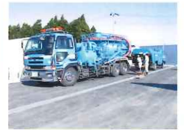
下水道管高圧洗浄車両
